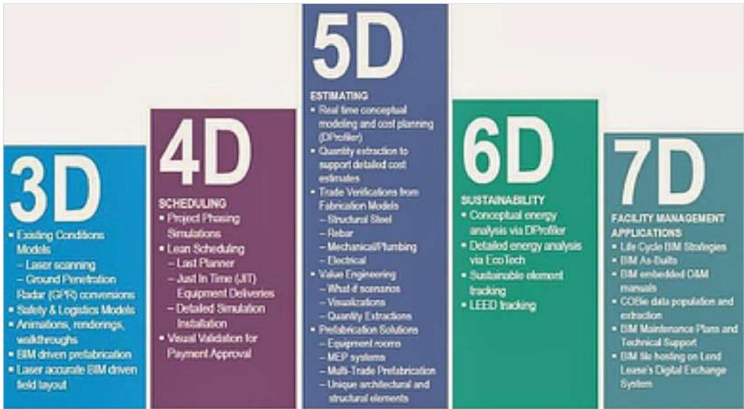
Figura 8. "BIM uses" para un proyecto. Fuente: BIM Project Ejección Planning Guide
