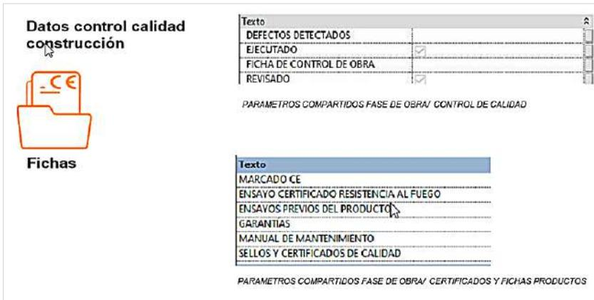
Figura 17. Protocolo BIM, para Revit, indicando nombres de parámetros para albergar en el modelo las labores de control de calidad de ejecución, y el control de calidad de la recepción de materiales. Fuente propia.
