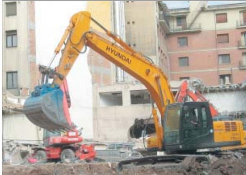
El motor, la cabina y el cilindro de elevación para mover el brazo de la pluma, están colocados por detrás del eje de rotación de la máquina para compensar el peso de los elementos de trabajo, aunque es precisa la ayuda de un contrapeso colocado en la plataforma.
