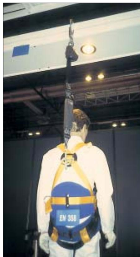
**Absorbedor de energía (banda de desgarro)**
