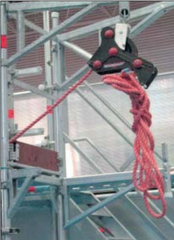
**Polea de montaje con freno de seguridad**
