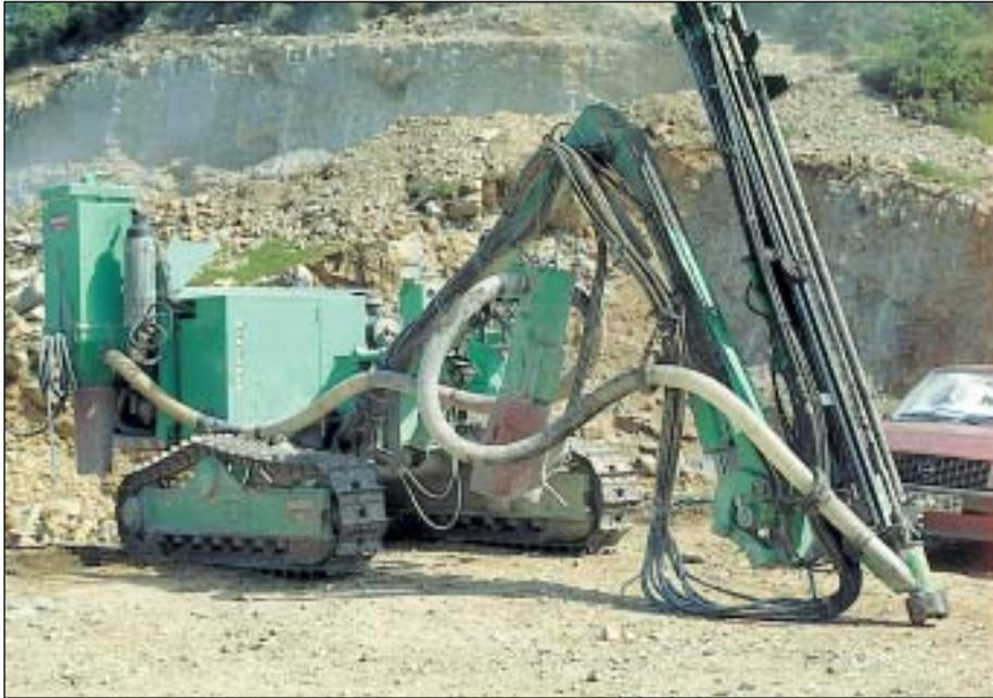
*Equipo perforador con colector de polvo*
