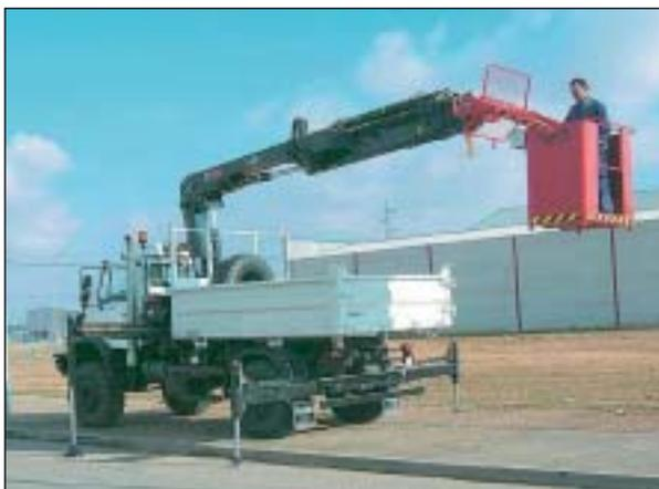
El taller instalador de la grúa sobre el vehículo deberá confeccionar el "**Expediente Técnico de Montaje**" de la unidad **COMPLETA (vehículo, grúa y cesta)** con el correspondiente "Certificado de Montaje", marcado CE y Declaración CE de Conformidad, que garantice el cumplimiento de las diferentes Normas (UNE-EN 12999 –Grúas cargadoras, UNE-EN 280 –Plataformas elevadoras móviles de personal)
