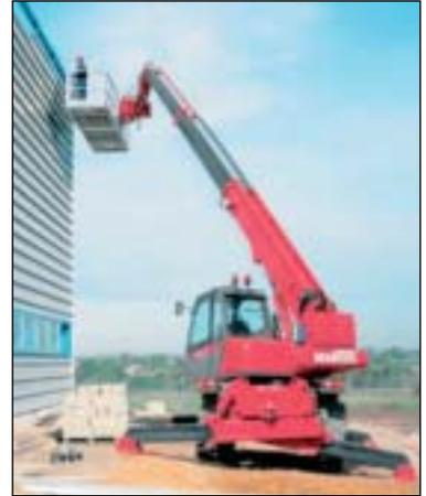
**Hay que tener cuidado en comprobar que la máquina, a la cual se acople la plataforma (jaula) para elevar personas, esté diseñada y certificada para tal fin,** porque pudiera ocurrir que mecánicamente la plataforma se pudiera acoplar a otras máquinas del propio fabricante que no estuvieran diseñadas para elevar personas
