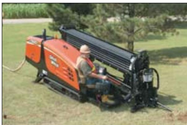
En ambos casos, la profundidad y dirección de la cabeza de perforación se controlan mediante un detector manejado desde la superficie, posibilitando trayectorias curvas.
