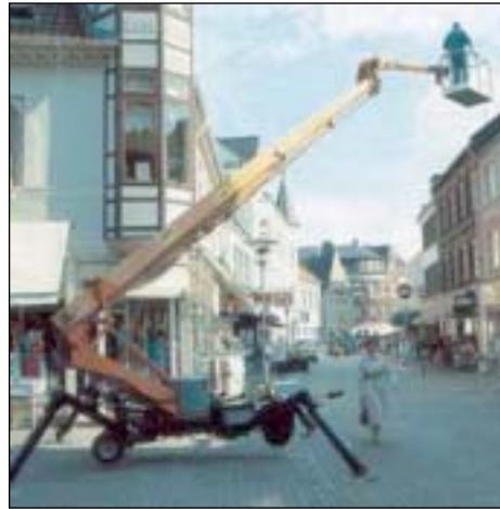
Se utilizan cuando el lugar de trabajo está desplazado respecto al punto de colocación de la plataforma (o la altura a alcanzar excede a las de tipo tijera)
