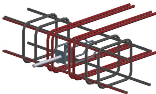
Figura 5.2: Disposición de los estribos de la armadura de suspensión y armadura de borde. Vista tridimensional.
