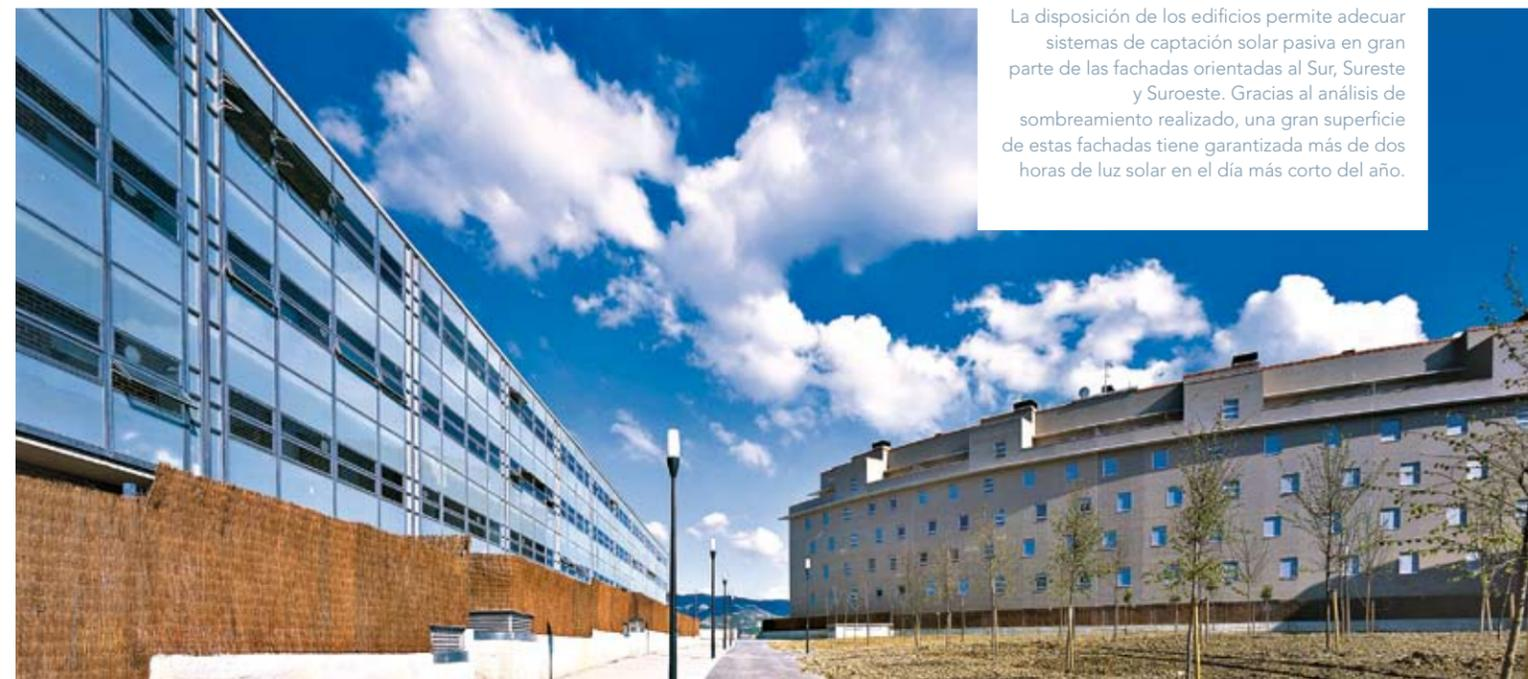
La disposición de los edificios permite adecuar sistemas de captación solar pasiva en gran parte de las fachadas orientadas al Sur, Sureste y Suroeste. Gracias al análisis de sombreado realizado, una gran superficie de estas fachadas tiene garantizada más de dos horas de luz solar en el día más corto del año.
