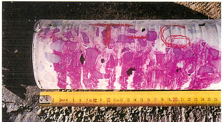
Testigo de hormigón extraído de la estructura tratado con fenolftaleína para conocer la profundidad del frente carbonatado.
