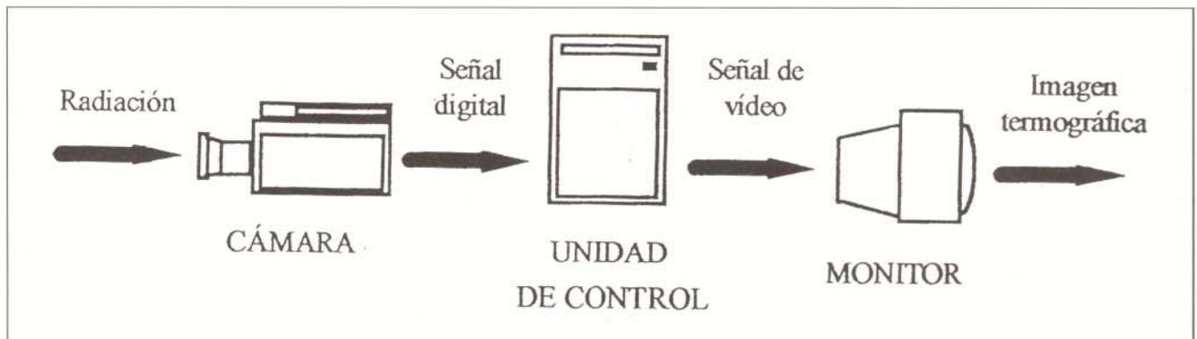
Figura 4: Proceso y componentes básicos de un equipo de termografía.
