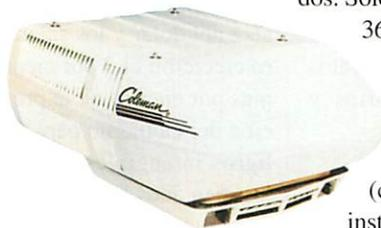
36 cm. y la carcasa de ensamble interior sólo tiene 8 cm. de altura desde el techo. Otras ventajas son la distribución de aire (tipo cassette), el bajo nivel de ruido (compresor rotativo) y su sencilla instalación, puesto que es compacto y no precisa de líneas de gas. Tiene una capacidad frigorífica de 3.500 kcal. y una resistencia de apoyo de 1.800 vatios. Funciona a 220 v., 50 hz., c.a.
