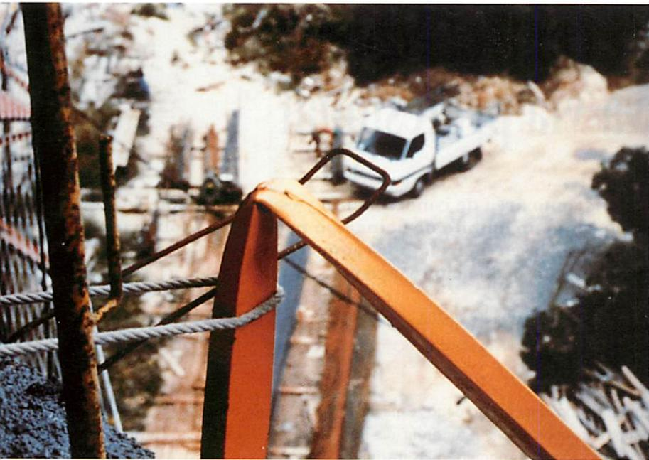
**Rotura del soporte de una red empleada en el estudio, a causa del eje débil.**
