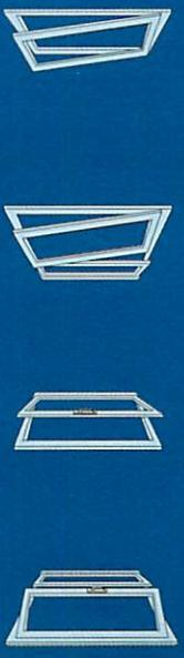
Interrupción del puente térmico existente entre el exterior e interior de la carpintería.
