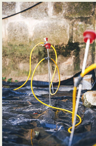
Análisis de la tomografía ERT 3D en tiempo real y disposición de los electrodos en el terreno.
