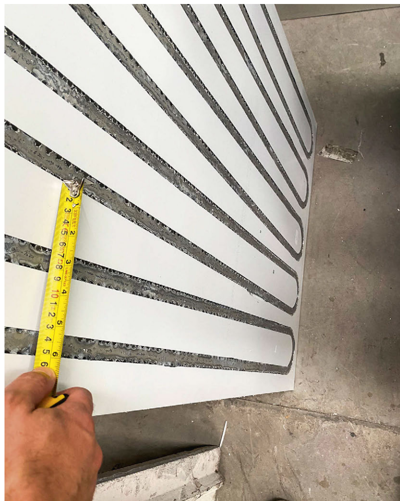
Parte posterior del panel de alta eficiencia Sunthal Dress, donde se aprecia el serpentín patentado.
