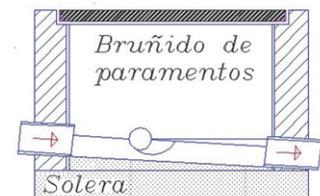
*El ángulo de conexión de los colectores debe ir a favor de pendiente*
