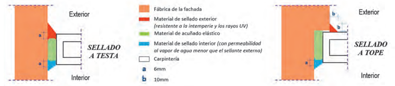
Fig. 5: esquema con los tipos de sellado de una carpintería con la mocheta del hueco de fachada.
