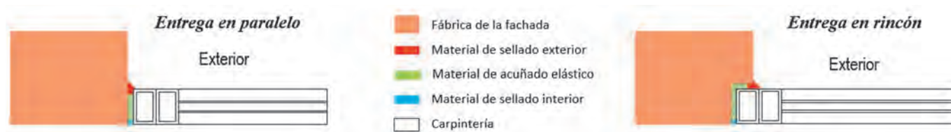
Fig. 4: esquema con los tipos de entrega de una carpintería con la mocheta del hueco de fachada.
