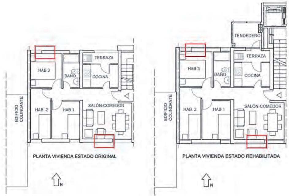
Figura 1: planos de planta de la vivienda en estado original y rehabilitada, y zonas de colocación de termopares. Elaboración propia.
