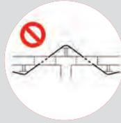
Pretensado mediante armaduras activas fuera del canto del elemento
