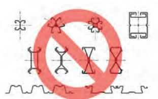
Se muestran algunos de los perfiles o chapas que quedan fuera del ámbito de aplicación del Código Estructural (imagen compuesta a partir de figuras de la norma UNE-EN 1993-1-3).
