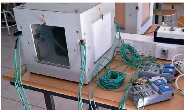
Figura 5: calibración de los termopares en la caja térmica. Laboratorio de física ETSEM. UPM.
