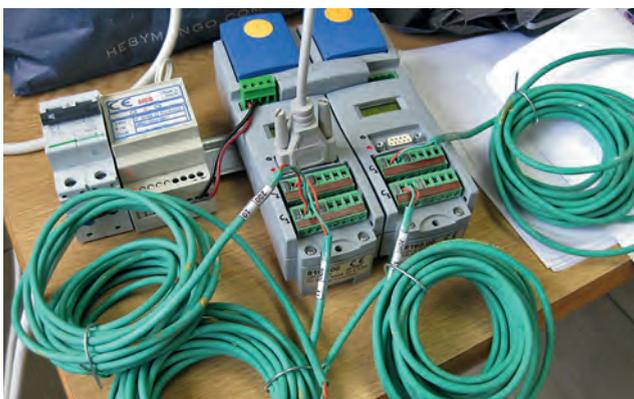
Figura 2: termopares tipo k y *dataloggers*.
