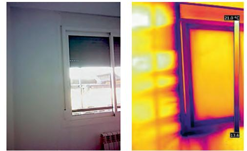
IMÁGENES 1 Y 2: se aprecian claramente las infiltraciones de aire exterior a través de la carpintería de la ventana, forzadas por la depresión ejercida por el ventilador del Blower Door.
