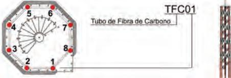
El sistema estructural del faro consta de ocho tubos verticales que funcionan como columnas que rodean el núcleo de la escalera.
