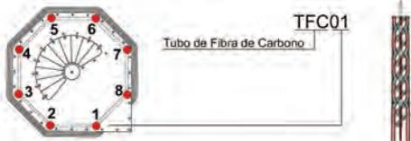
El sistema estructural del faro consta de cinco forjados horizontales intermedios y una cubierta superior, que cumplen la doble función de arriostrar los tubos perimetrales y solidarizarlos con el núcleo de la escalera, y de plataformas de descanso requeridas por la normativa actual de edificación (CTE).
