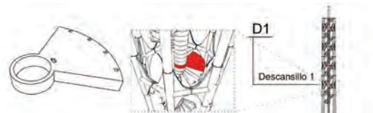
El sistema estructural del faro consta de cuatro plataformas de descanso, que forman parte de la escalera de caracol.
