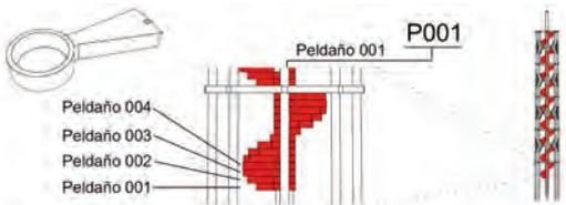
La estructura dispone de una escalera de caracol fabricada en fibra de vidrio. Los peldaños están formados por un anillo de 60 cm de diámetro interior, del que arranca una plataforma de planta trapecial, de 90 cm de longitud, realizada en panel tipo sándwich, de huella en el eje de 26 cm y la contrahuella de 20 cm.
