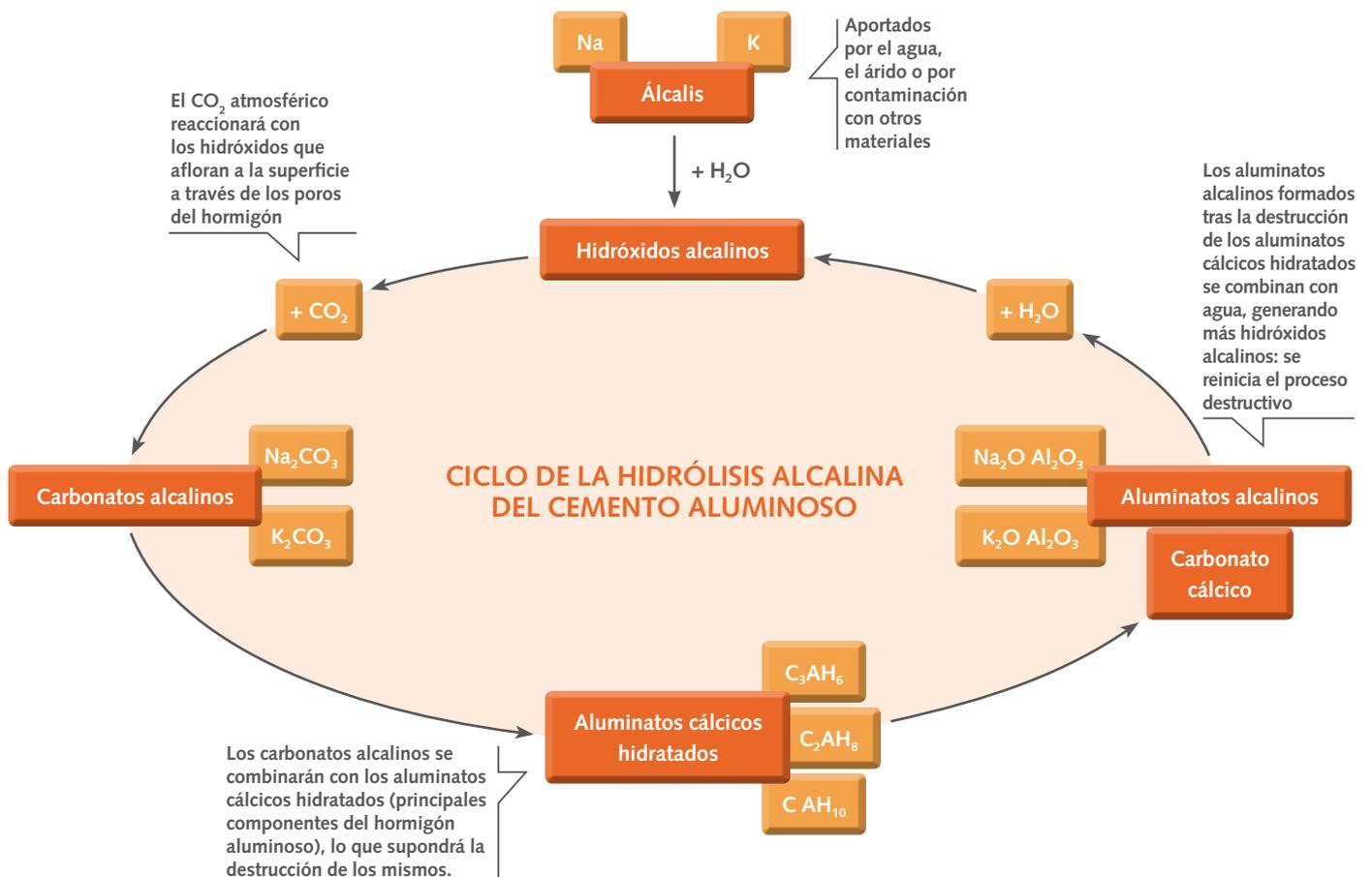
vado porcentaje de porosidad que adquiere tras los procesos de conversión (sin olvidar la influencia en la porosidad que puede tener la relación agua cemento y las condiciones de curado), permite la carbonatación del hormigón aluminoso y el ataque de agentes externos que penetran a través de los poros. La capa pasivante se ve muy interrumpida por el tamaño y número de los poros.
