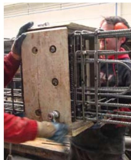
A la izquierda, las barras de espera de los distintos forjados se disponen en el armado de la pantalla dobladas y protegidas con porexpan y malla de acero galvanizado. A la derecha, montaje en taller del manguito de unión de barras en pilar. Abajo, zona de acopio y curado de pilares prefabricados en las instalaciones de la fábrica.
