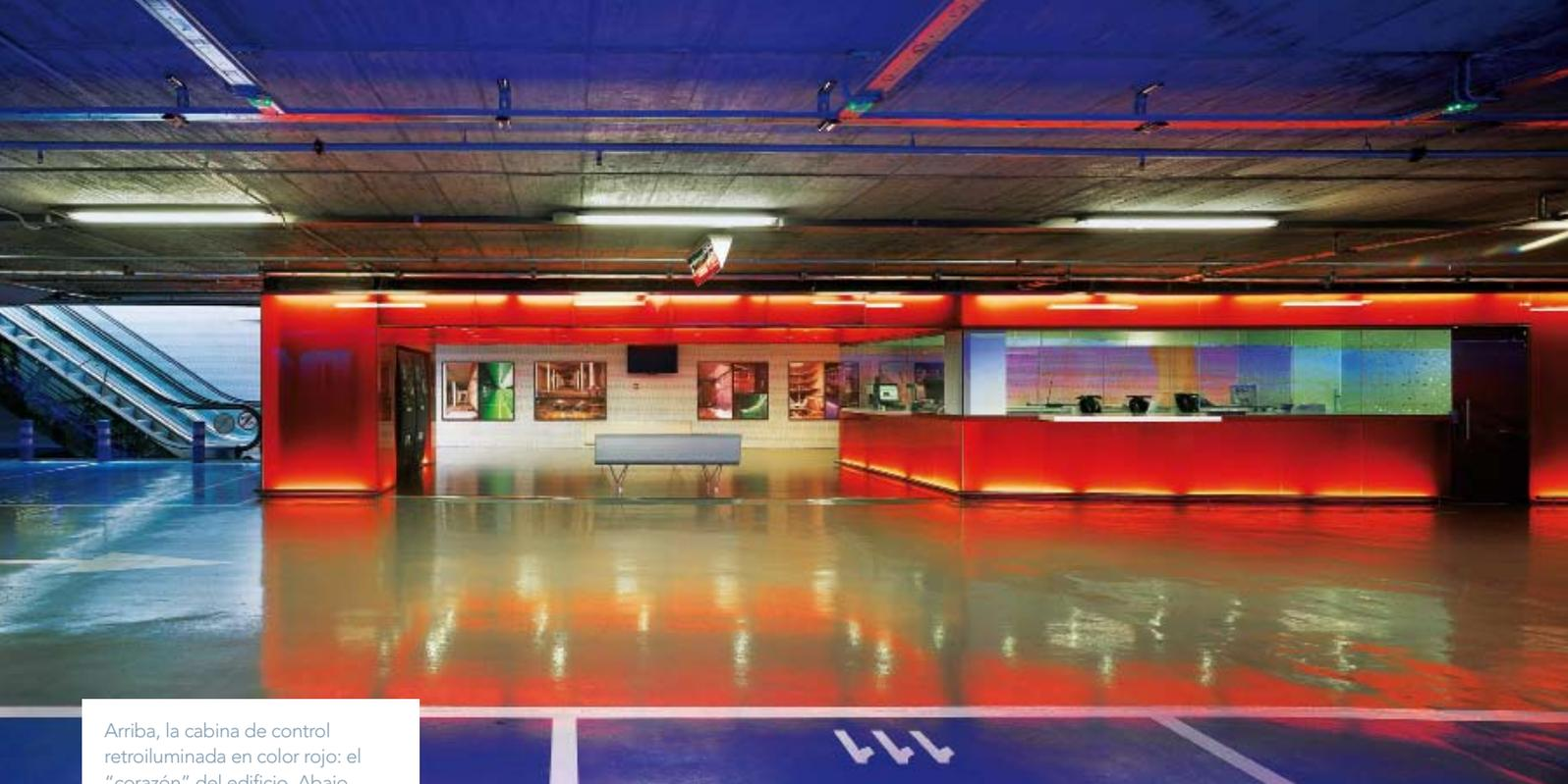
Arriba, la cabina de control retroiluminada en color rojo: el "corazón" del edificio. Abajo, los fuertes colores impresos a las plantas se consiguen mediante tubos fluorescentes, vidrios y pavimentos de resina, todos ellos del color de cada planta.
