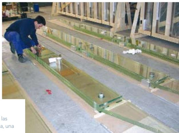
A la derecha, fabricación de las vigas de vidrio. A la izquierda, una de ellas colocada en obra.
