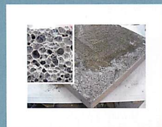
Placas porosas elaboradas con ceniza volante activada alcalinamente.
