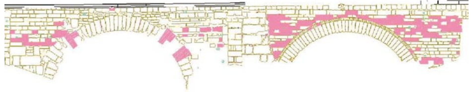
Reposición de sillares de arenisca-calcarenita tallados de las piezas reutilizadas del pretil desmontado.
