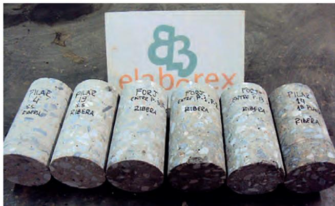
Fig. 12: testigos de hormigón de 100 mm de diámetro.
