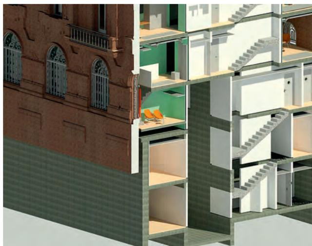
**Revestimientos interiores y acabados.** Como revestimiento de acabado en paramentos verticales se han utilizado guarnecidos y enlucidos de yeso sobre los paramentos de fábrica de ladrillo cerámico; revocos de mortero acabados con un estuco en las paredes de la escalera principal; panelados ignífugos de madera en paredes de pasillos y habitaciones; revestimientos de chapa metálica en paredes y mobiliario de la zona del restaurante, y alicatados de gres en cuartos húmedos y zonas de servicio
