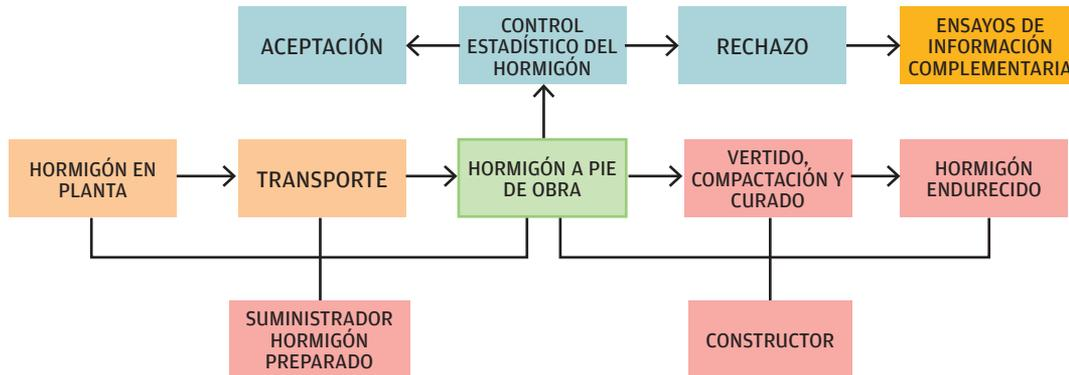
Fig. 3: esquema del suministro, vertido, compactado y curado del hormigón preparado hasta su endurecimiento en obra.
