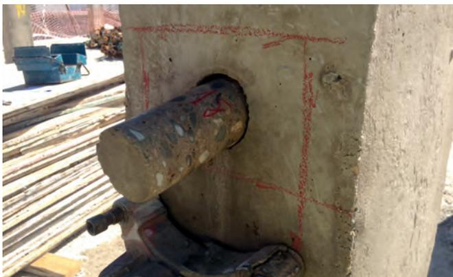
Fig. 11: testigo de hormigón de 75 mm de diámetro en pilar.
