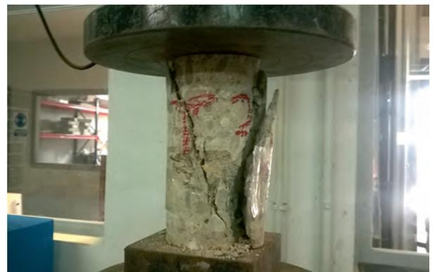
Fig. 2: rotura a compresión probeta hormigón.
