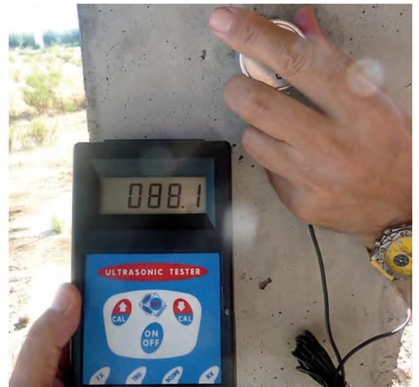
Fig. 10: velocidad de propagación de ultrasonidos.
