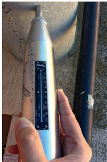
Fig. 9: índice de rebote. Esclerómetro.
