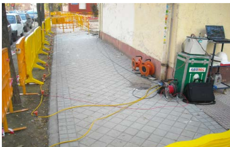
Figura 3: Implantación y realización de ensayos E.R.T. 3D diagnóstico.
