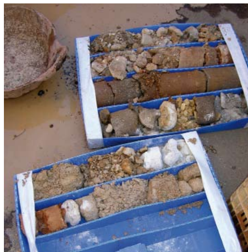
Arriba, caja de muestras SPT. Abajo, a la izquierda, rotura del testigo de hormigón.
