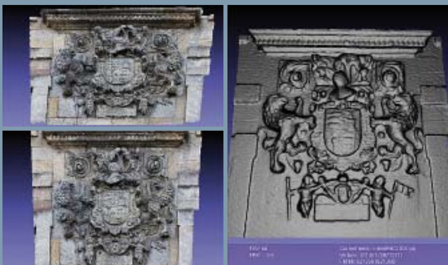
Reproducción por nube de puntos de un escudo nobiliario de dimensiones aproximadas de 2 x 2 m. La distancia de fotografiado fue de 8 m y el tiempo de restitución, una hora. En la zona derecha se observa el mapa de sombras para apreciar en detalle el relieve. La nube tiene unos 2,5 millones de puntos.
